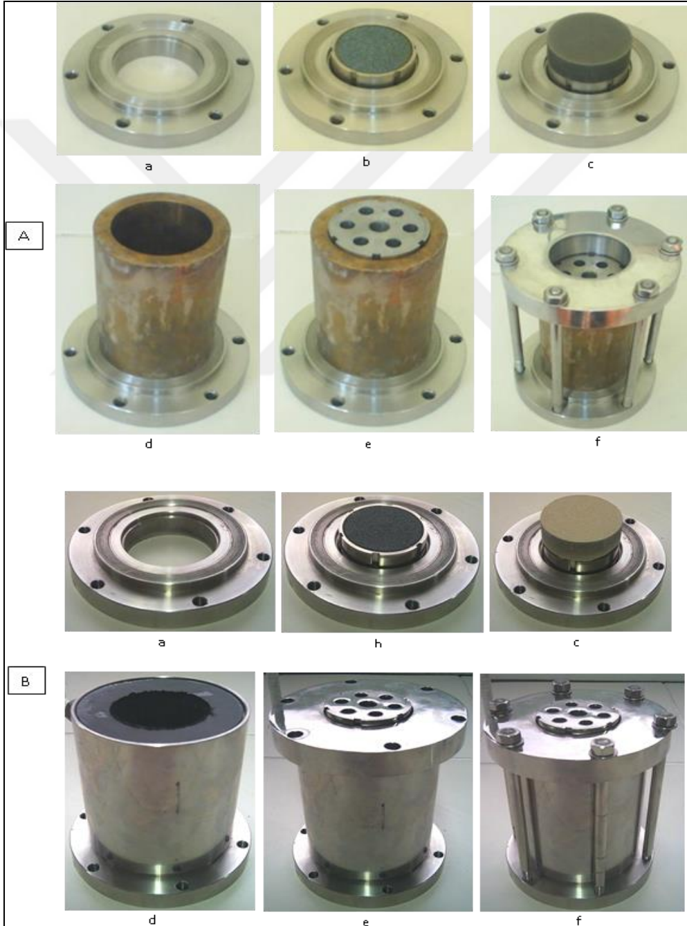
Şekil 4.3 Tek (A) ve üç (B) eksenli şişme hücresinin kurulum aşamaları (a-f).
