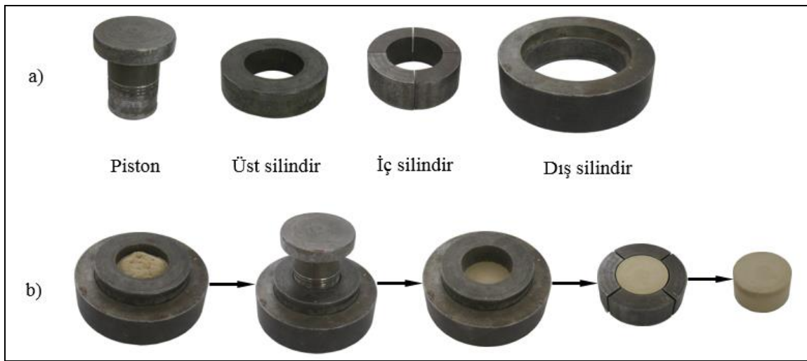
Şekil 4.1 Örnek hazırlama aparatının a) parçaları ve b) uygulama aşamaları.
