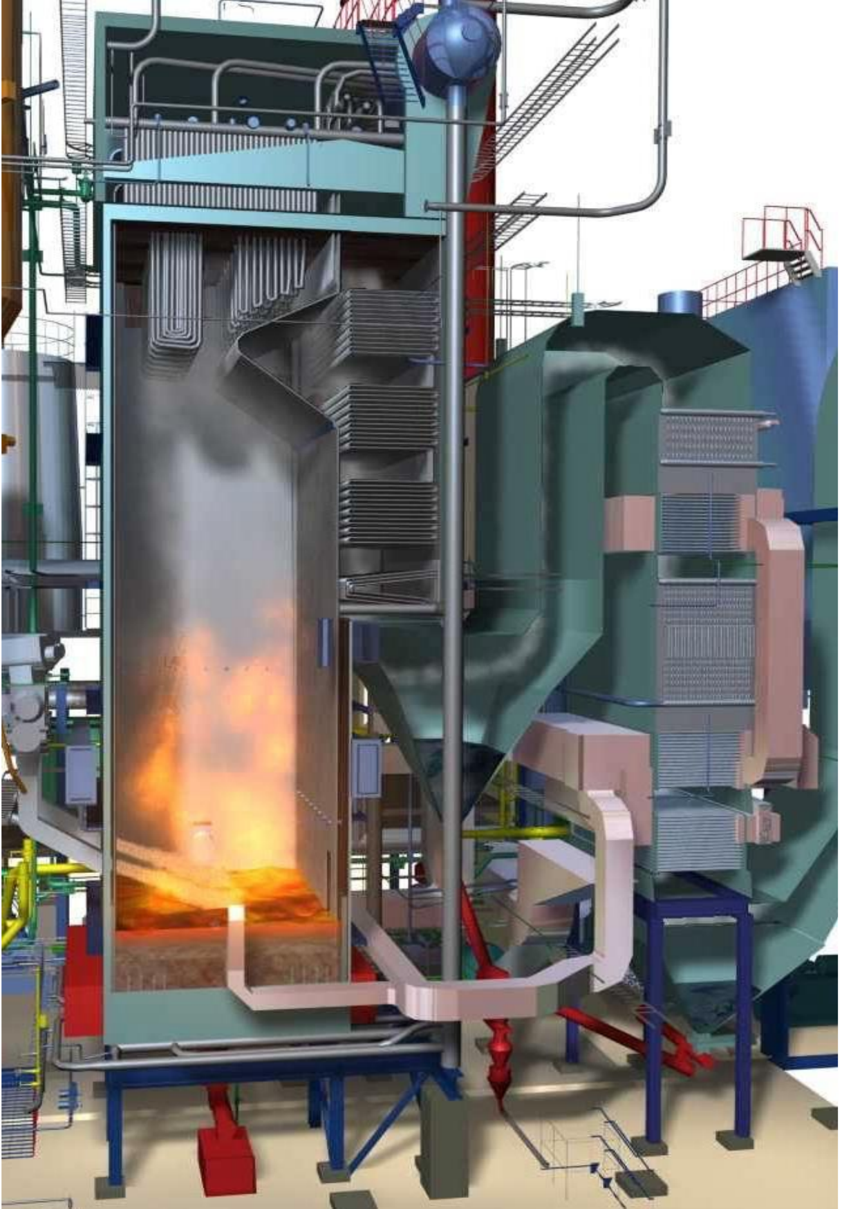
Şekil 2.3 Akışkan yatak kazan kesit görünümü (Teir 2003).
