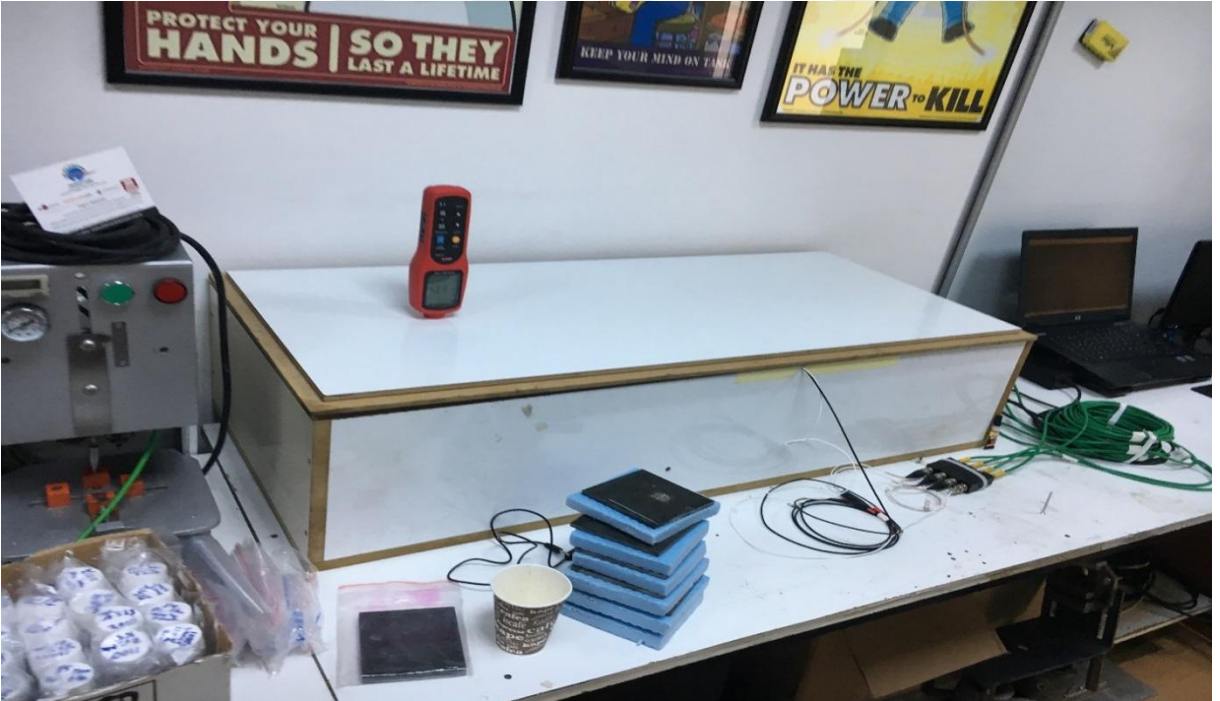
Şekil 3.3 Kapalı deney düzeneği ve desibel metrenin deney düzeneğinde görünümü.
