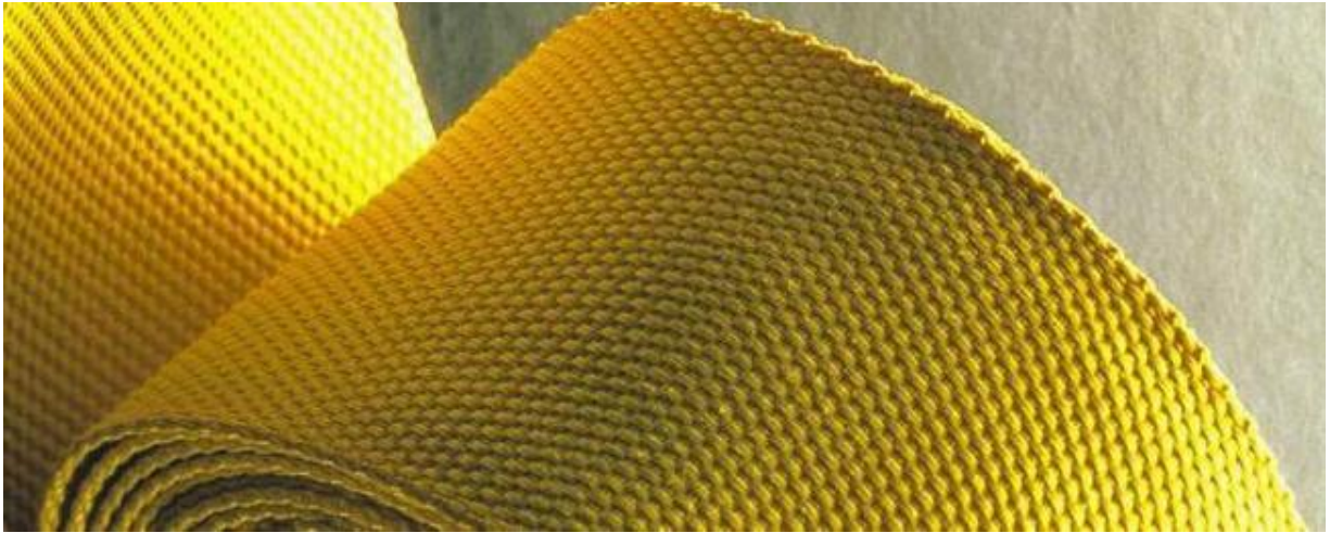
Şekil 2.3 Aramid takviyeli fiber kesiti (URL-2).
