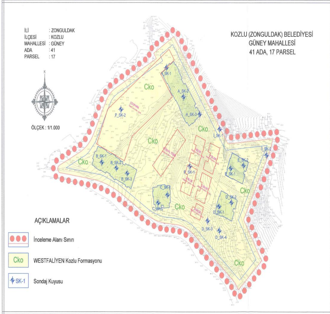
Şekil 3.7 Vaziyet planında sondajların yeri.
