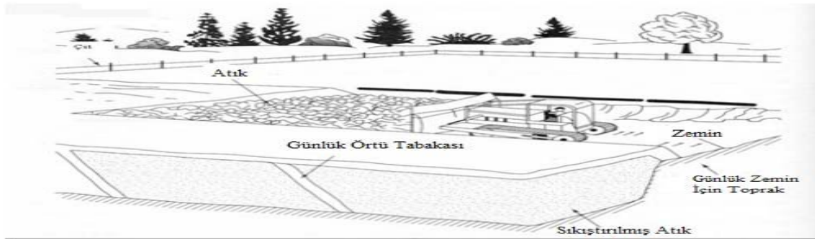
Şekil 3.6 Düzenli depolama tesisinde hendek metodu [54].
