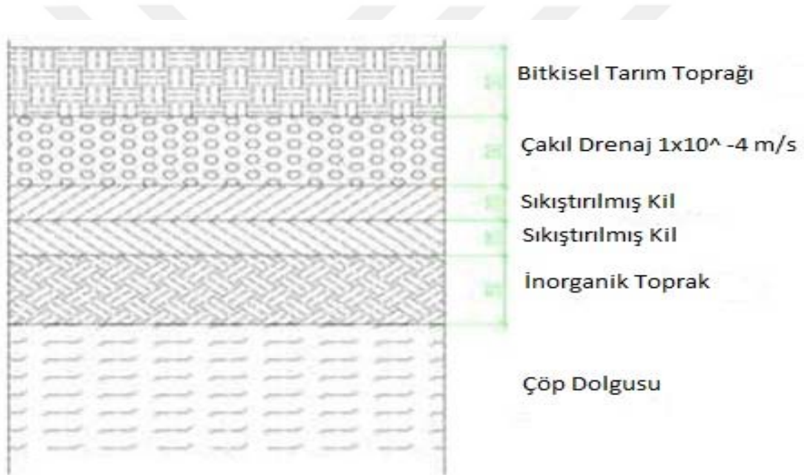
Şekil 3.5 Tipik saha üst örtü teşkili [17].
