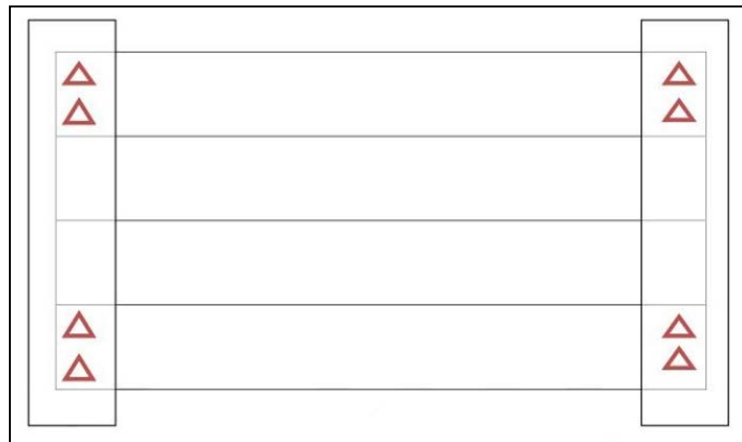
Şekil 2.2 Kinematik GNSS destekli fotogrametrik nirengi yöntemine göre YKN sayısı ve dağılımı [29].
