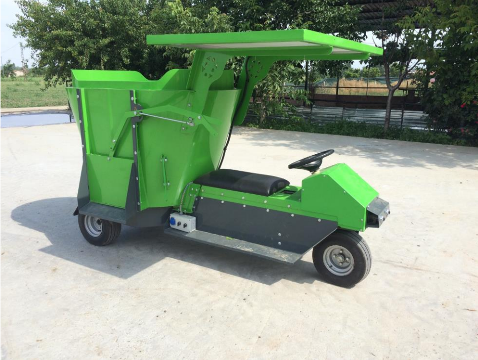
Şekil 4.10. İmalatı tamamlanmış güneş enerjisi destekli elektrikli yem karma makinesi
