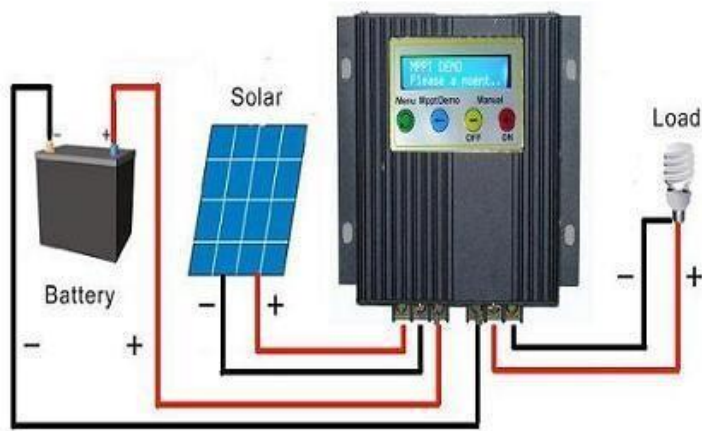
Şekil 3.9. Dönüştürücü, güneş paneli ve akünün bağlantı şeması
