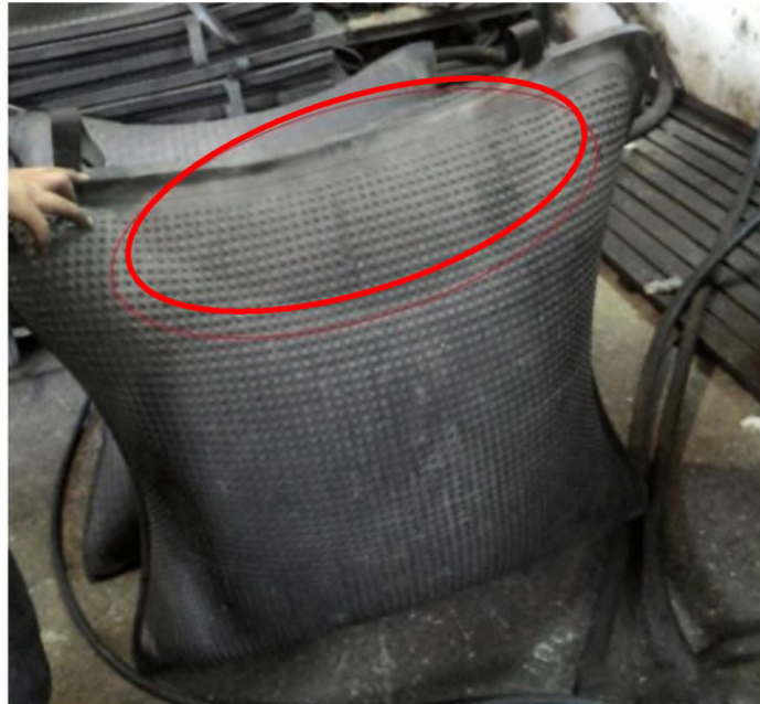
Şekil 4.27 Hava yastıklarında meydana gelen balonlaşma arızası.
