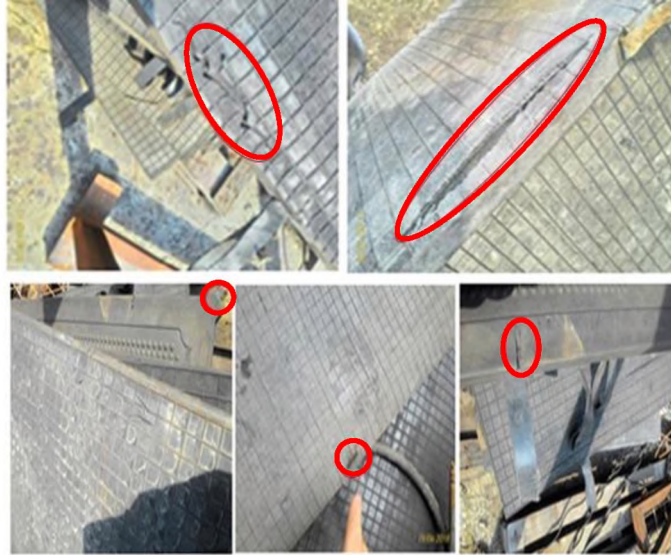
Şekil 4.22 Hava yastıklarında meydana gelen deformasyonlar.
