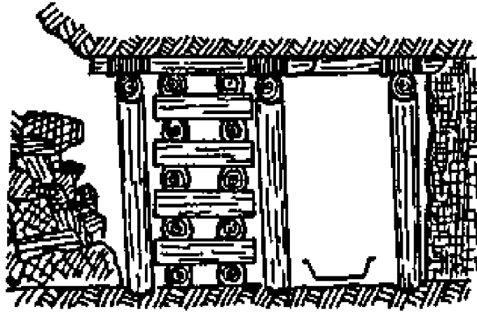
Şekil 3.7 Domuzdamının arına paralel ahşap tahkimatlı uzunayakta ayak arkasının göçertilmesinde kullanımı (Ünlü ve Gerçek 2000).
