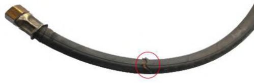
Şekil 4.21 Sava marka hava yastığına ait hortumda meydana gelen yarıma.
