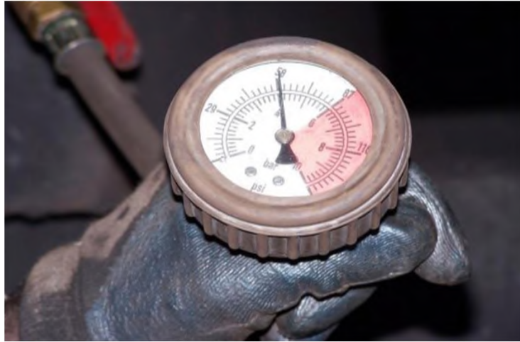
Şekil 4.11 Basınç ölçümünde kullanılan manometre (Dağdelen vd 2009).
