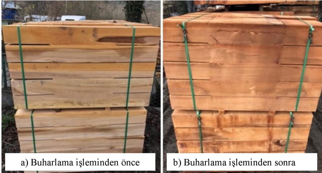
Şekil 4.5 HDD malzemesine buharlama işlemi yapılmadan önceki ve sonraki hali.
