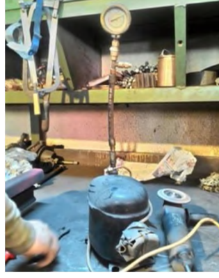
Şekil 4.24 Hava yastıklarının hortum kısmının sızdırmazlık testi ve emniyet valfinin ayarlanması.
