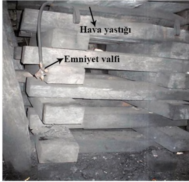
Şekil 4.12 TTK ocaklarında kullanılan ÖGADD sistemi (Dağdelen vd. 2009).
