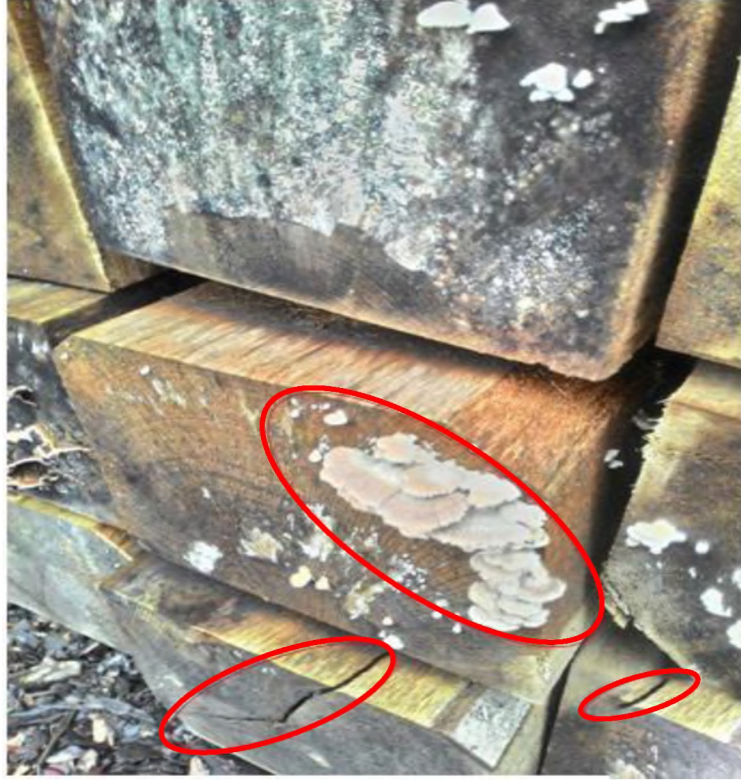
Şekil 4.6 HDD malzemesinde meydana gelen çatlama ve mantar oluşumu.
