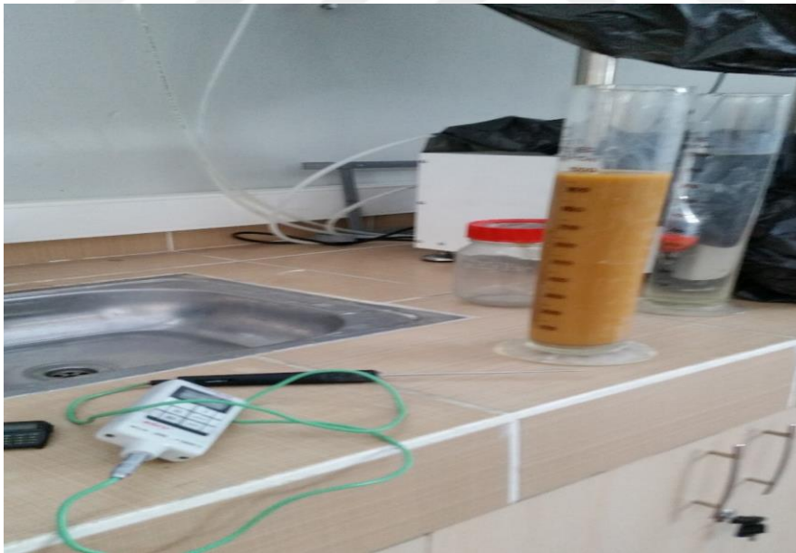
Şekil 5.3 Hidrometre deneyi yapılışı.
