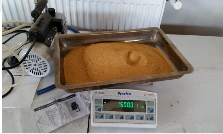
Şekil 5.7 Sıkıştırma deneyi numunesinin hazırlanması.
