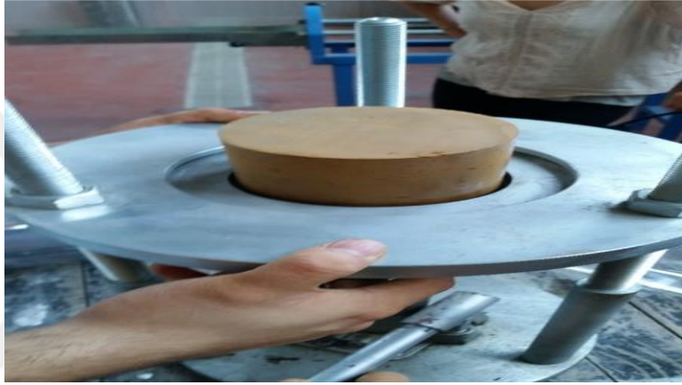
Şekil 5.12 Numunenin mold'dan çıkarılması.
