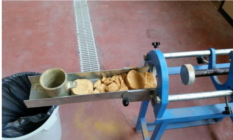
Şekil 5.13 Kompaksiyon yapılan numunenin su içeriğini belirlemek üzere numuneden örnekler alma işlemi
