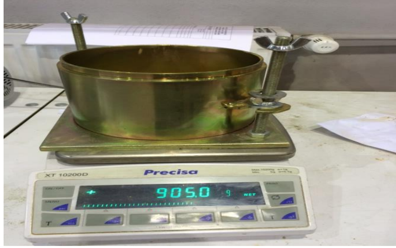
Şekil 5.8 Sıkıştırma deneyinde kullanılan ekipman (mold).
