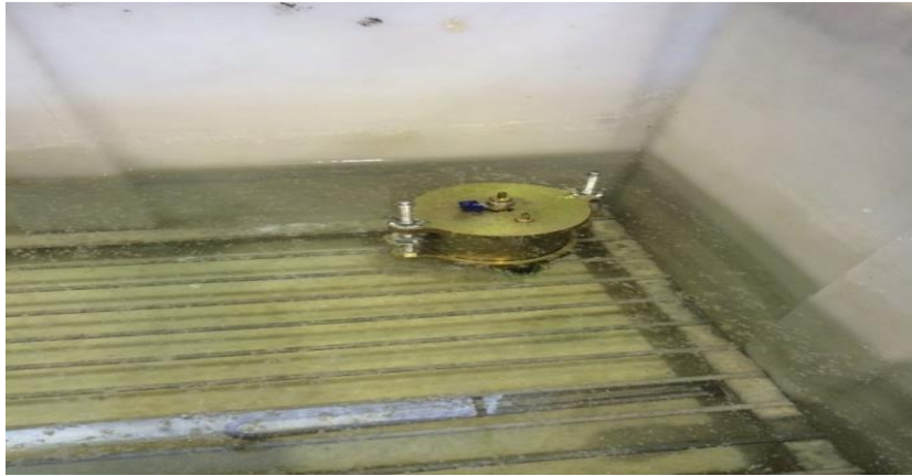
Şekil 5.16 Havuzda bekletilen kompaksiyon kalıbı (Mold).
