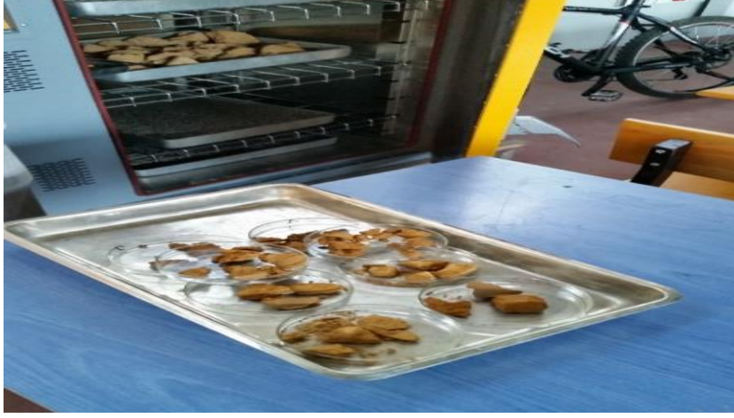
Şekil 5.14 Kompaksiyon yapılmış numunenin örneklerinin 105 °c derece etüvde kurutulması işlemi.
