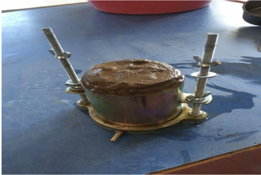
Şekil 6.1 Termik santral uçucu külü %100 oranında kullanımı düşen seviyeli permeabilite deneyi.
