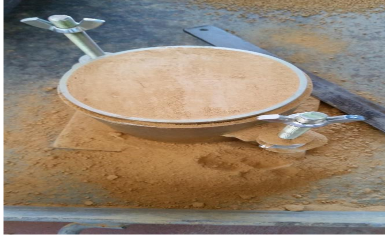
Şekil 5.11 Kompaksiyon işlemi tamamlanmış numune.
