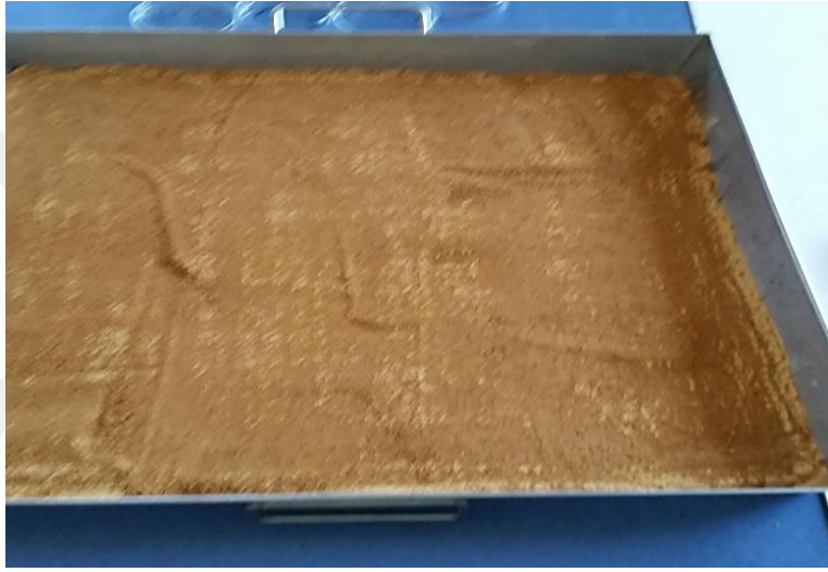
Şekil 5.9 Numune 2, nemlendirme işlemi.
