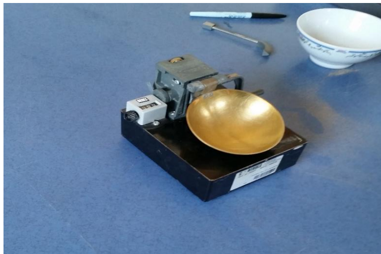
Şekil 5.5 Cassagrande çarpmalı deney cihazı, oluk açma bıçağı, porselen pota.
