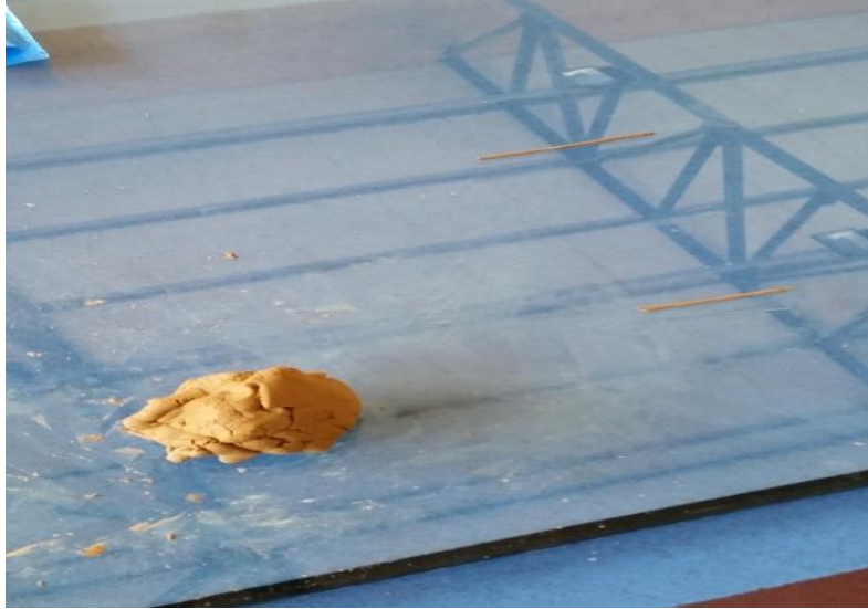
Şekil 5.6 Karıştırılan numunenin plastik limit hesabı için 3 mm olana kadar yuvarlama işlemi.
