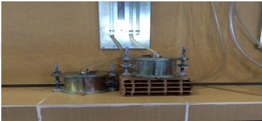
Şekil 5.18 Permeabilite deney düzeneği ve moldların bağlanılma şekli.
