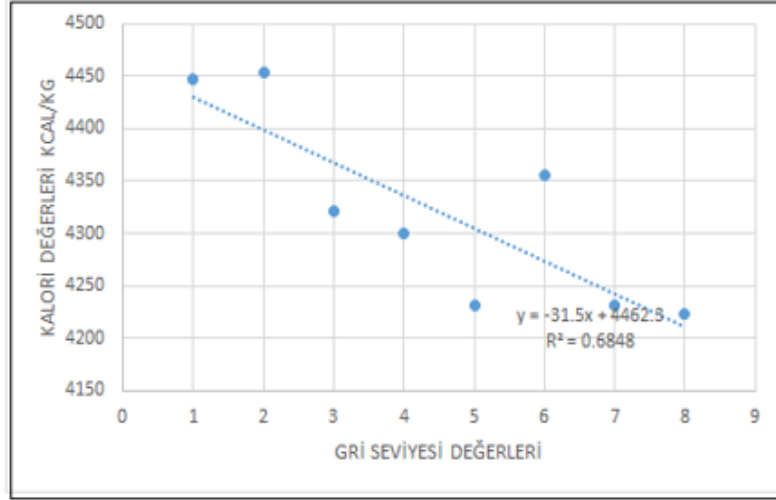
Şekil 4.12 Ömerler kömür örneklerinin Gri Seviyesi Değerleri ve Kalori Değerleri Arasındaki Korelasyonun Grafiği.
