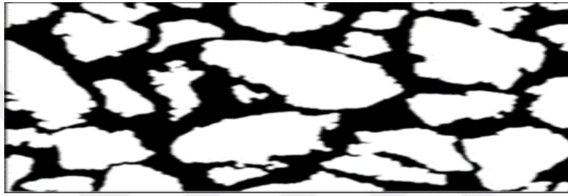
Şekil 3.6 Kenarları görüntü işlemeyle algılanan kömür parçacıklarına ait görüntü (Zelin et al. 2012).
