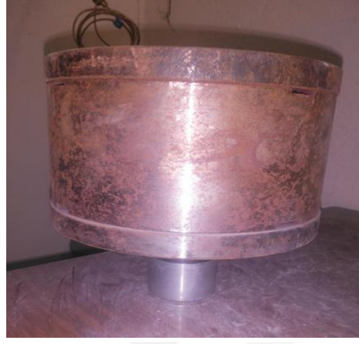
Şekil 4.2 Kömür numunelerinin üzerine ağırlık uygulaması işlemi.
