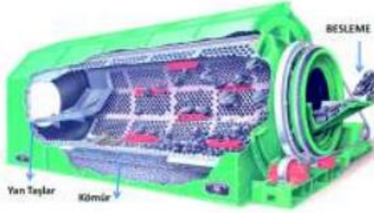
Şekil 2.2 Bradford Kırıcısı ile Zenginleştirme (Alderman 2001).
