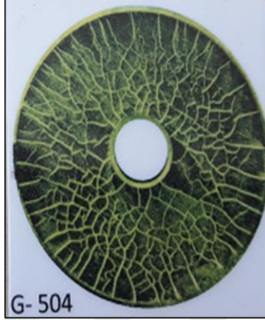
Şekil 6.16 Multiflux ift 1400 g AC/DC Ultraviyole çatlak kontrol cihazı ile çekilmiş fotoğraf.
