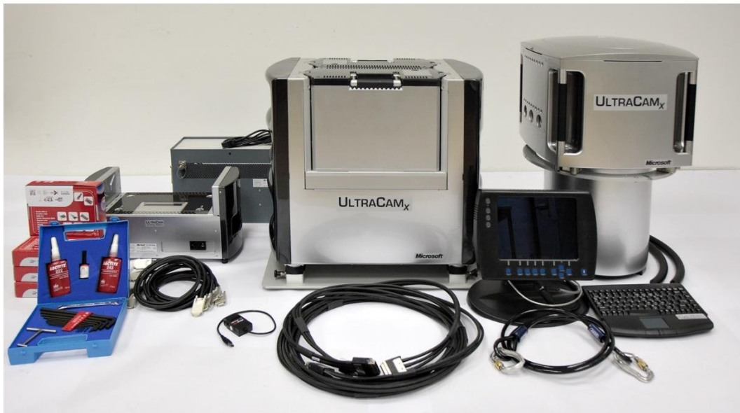
Şekil 4.13 Microsoft UltraCam-X büyük formatlı hava kamerası.
