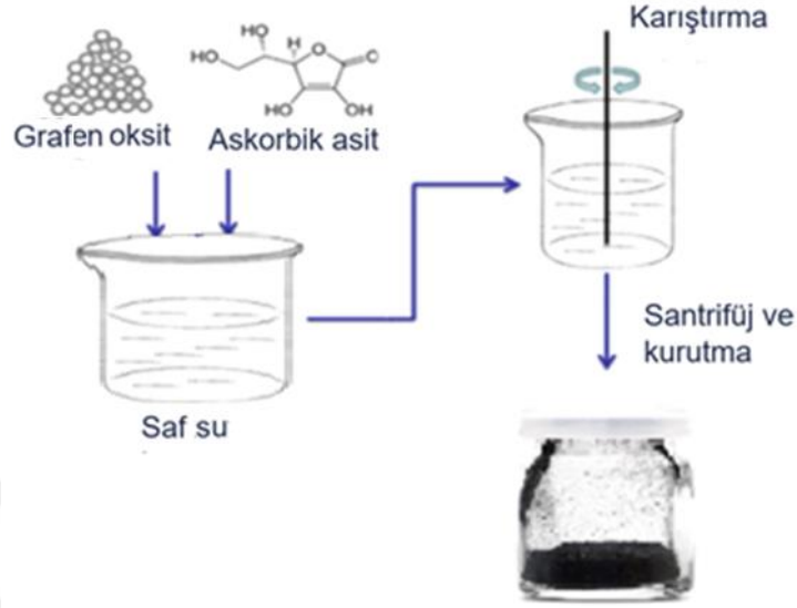
Şekil 3.2 rGO sentezinin şematik gösterimi.
