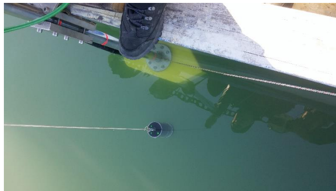
Şekil 4.67 GPS Kurulumu, Bar Check ve Ses Hızı Ölçümü
