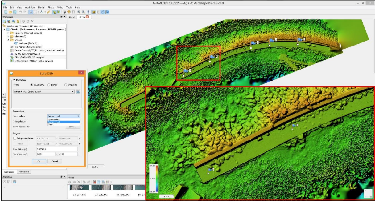
Şekil 4.32 5.5 cm/ Pix Çözünürlükte Ana Mendirek Sayısal Yükseklik Modeli Üretilmesi
