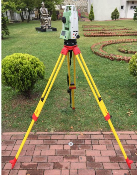
Şekil 3.8 Poligon üzerine kurduğumuz total station.
