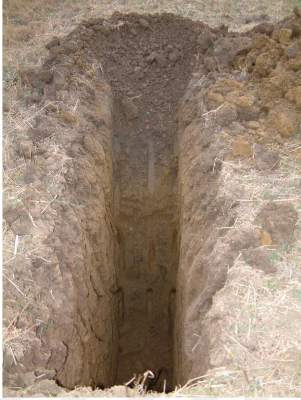
Şekil 7.1 AÇ-1 ait kazı görüntüsü (bozunmuş kumtaşı).
