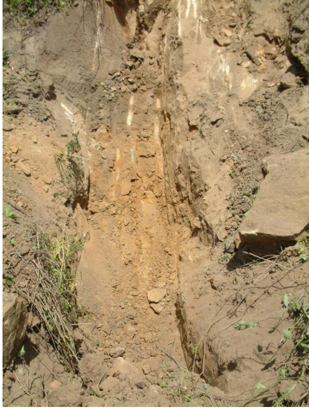
Şekil 7.2 AÇ-2 ait kazı görüntüsü (bozunmuş kumtaşı)
