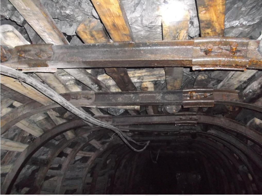
Şekil 3.17 B8 kesitli rijit çelik bağ parça eklenerek kesit genişletme.
