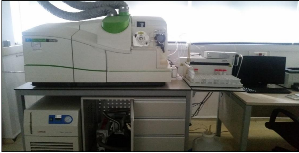
Şekil 4.12 Perkin Elmer marka Nexion 300D model ICP-MS cihazı.
