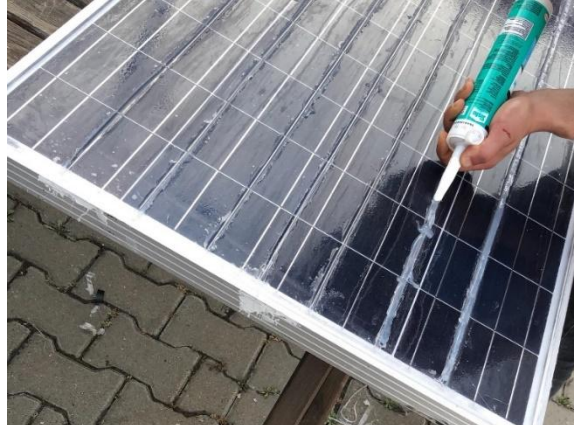
Şekil 3.17 Silikon ile kanalların oluşturulması.
