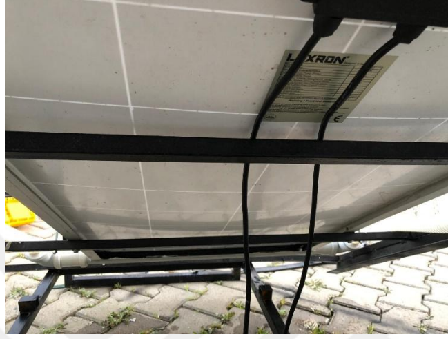
Şekil 3.14 PV-T sisteminin arka yüzeyinin şişmesi.
