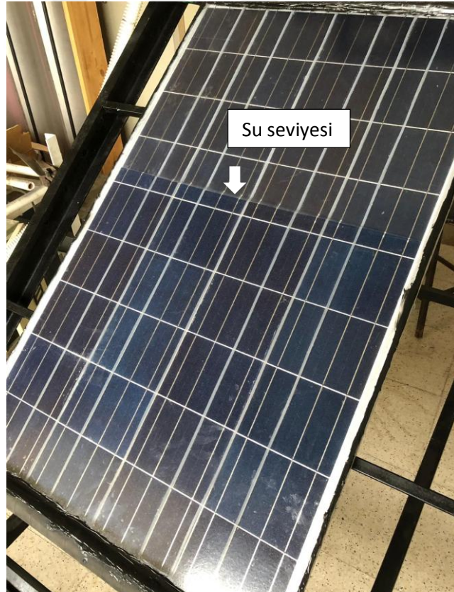
Şekil 3.10 Kauçuk malzemeden yapılmış kollektörler ile sistem denemesi ve cam ile PV panel arasında akan suyun camların şişmesinin görülmesi.
