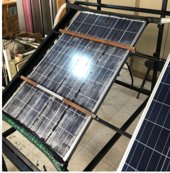
Şekil 3.11 Metal plakaların sisteme eklenmesi.
