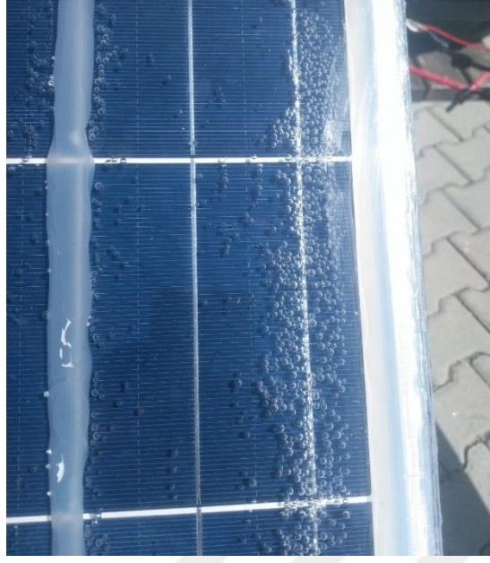
Şekil 3.22 PV-T sisteminin üzerinde oluşan kabarcıklar.
