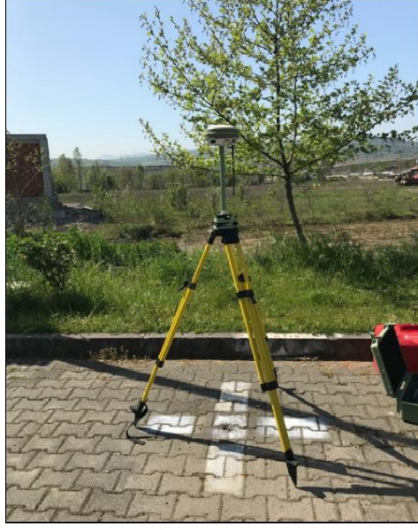
Şekil 4.3 SATLAB SL 6000 GNSS Aleti ile YKN Ölçümü.
