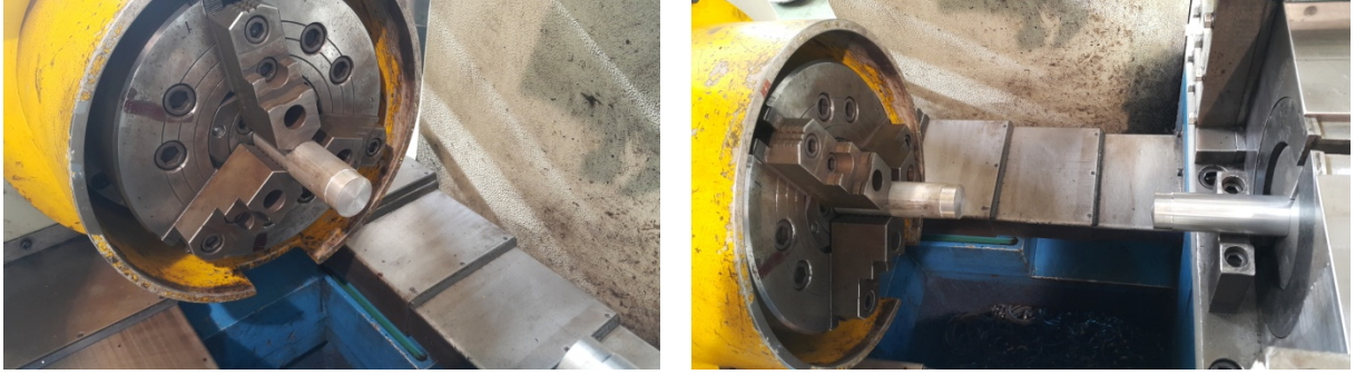
Şekil 4.1 Kısa malzemenin (AA6013) sürtünme kaynak makinesine bağlanması.
