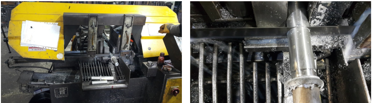
Şekil 4.3 Kaynaklı numunelerin eşit boyda kesilmesi.
