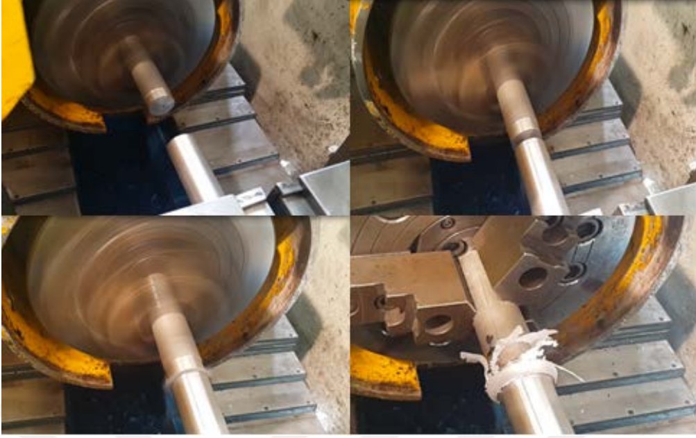
Şekil 2.2 Dairesel sürtünme kaynağında işlem aşamaları.
