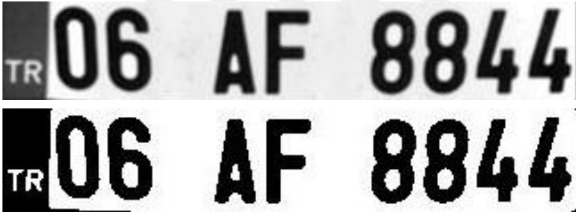
Şekil 4.6 Otsu metodu ile plaka görüntüsünün ikili formata çevrilmesi.
