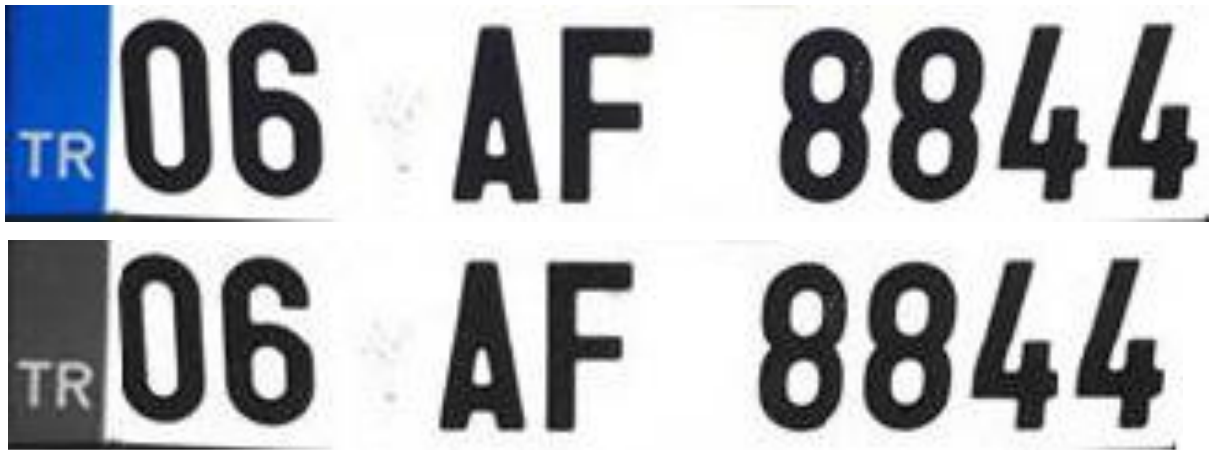
Şekil 4.3 Renkli görüntünün gri seviye görüntüye dönüştürülmesi.
