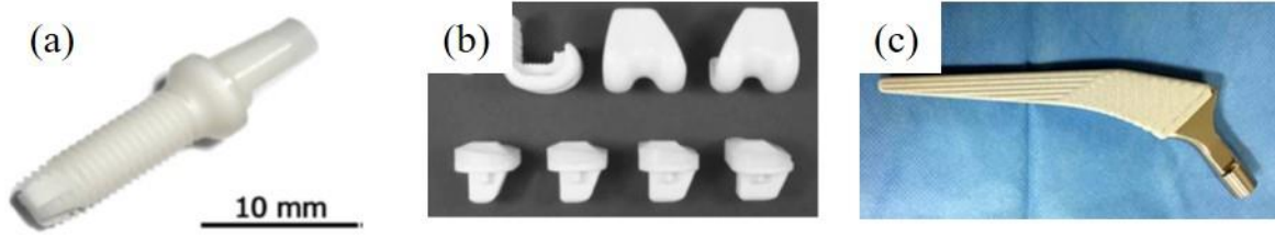
Şekil 1.10 a) Zr diş implantı [17], b) çeşitli Al_2O_3 biyomalzemeler [18] ve c) HA kaplanmış Ti-6Al-4V implant [19].
