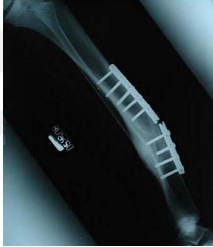
Şekil 1.18 Bir hastada hasara uğramış paslanmaz çelik implantın radyografik görüntüsü [78].
