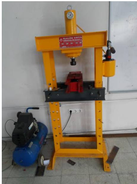
Şekil 3.7 Tozların sıkıştırıldığı 20 ton kapasiteli pres.
