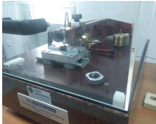
Şekil 3.14 Aşınma testinin gerçekleştirildiği Tribotechnic marka pin-on disk cihazı.
