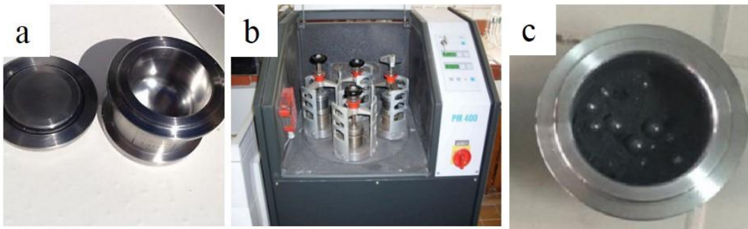
Şekil 3.2 a) Öğütme işlemi öncesindeki paslanmaz çelik hazneler, b) Retsch PM-400 cihazı ve c) mekanik alaşımlama işlemi sonrası çelik hazne.
