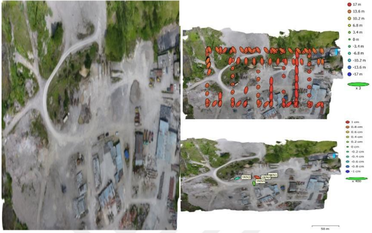
Şekil 3.12 50 m irtifa uçşların konum hatalarının ortomozaik üzerindeki görüntüsü.
