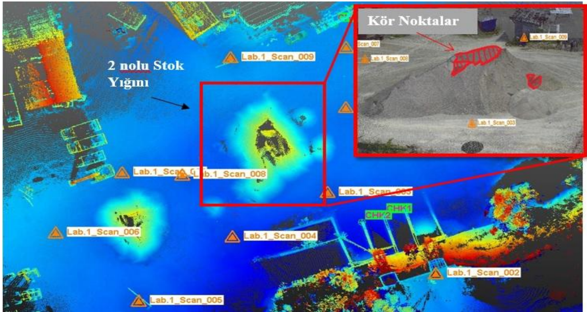
Şekil 5.4 Stok yığınındaki kör noktalar.
