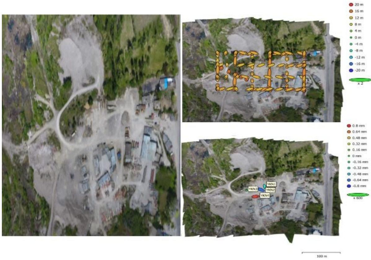
Şekil 3.13 100 m irtifa uçşların konum hatalarının ortomozaik üzerindeki görüntüsü.
