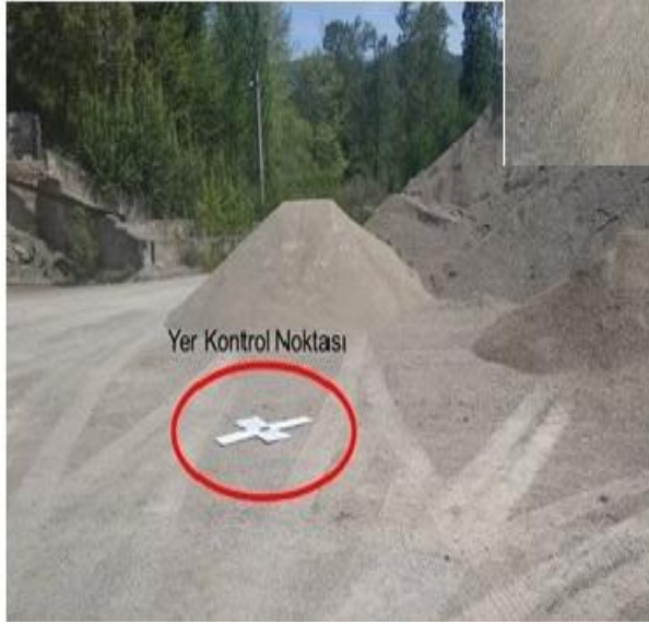
Şekil 3.5 Sahada GNSS ölçümlerine ait görüntüler.
