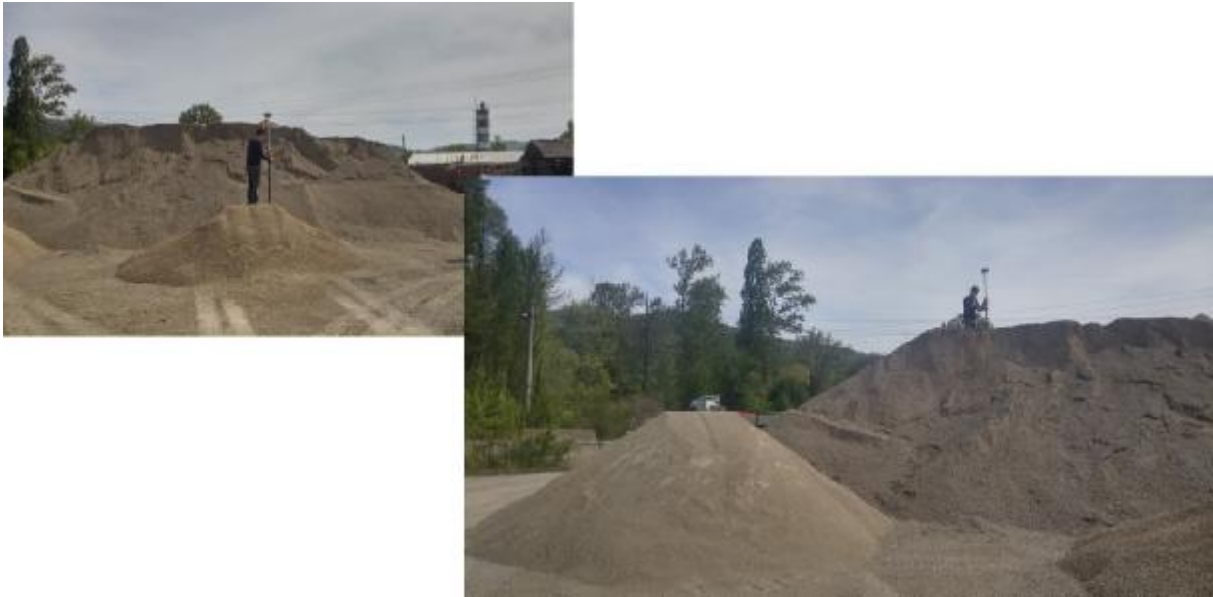
Şekil 5.10 2 nolu stok yığnında GNSS cihazı ile operatör ölçümü.
