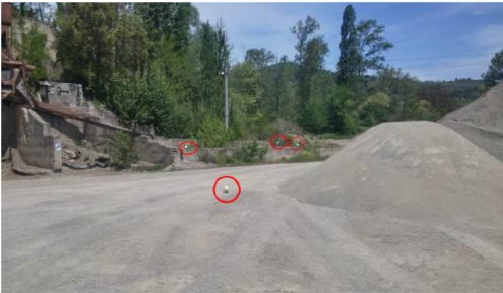
Şekil 3.8 Lazer tarayıcı ölçüm kürelerinin saha içindeki konumları.
