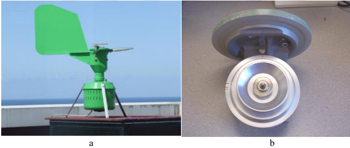
Şekil 2.1 Burkard Cihazının genel görüntüsü, b. Burkard cihazının içerisinde yer alan ve şeffaf bantın sarıldığı döner disk.
