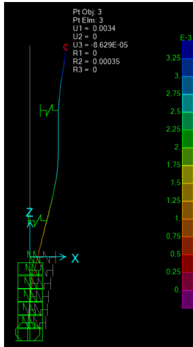
Şekil 4.49 Durum 9 için yatay deplasman diyagramı doygun zemin durumunda.
