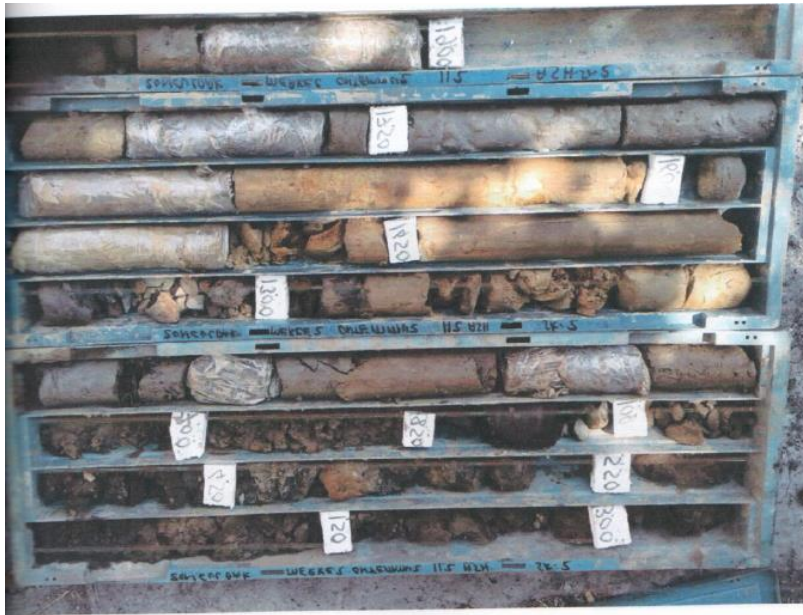
Şekil 3.9 SK-2 Numunesine ait Karotlar.
