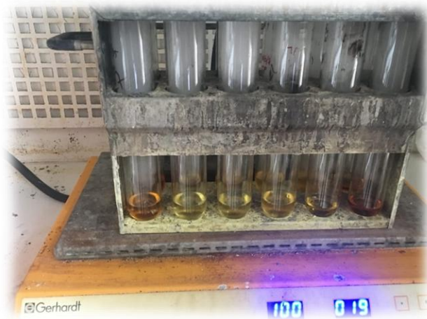
Şekil 3.9. Gerhardt cihazında örneklerin bakılması
