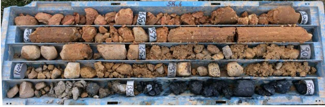
Şekil B.4 SK-4 kuyusu 0.00-15.00 metre karot sandığı.
