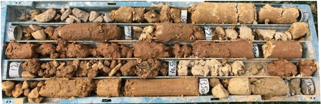
Şekil B.3 SK-3 kuyusu 0.00-15.00 metre karot sandığı.
