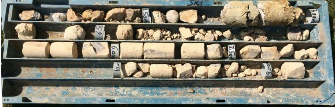
Şekil B.1 SK-1 kuyusu 0.00-10.00 metre karot sandığı.
