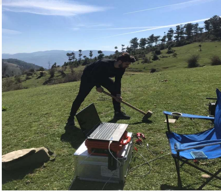
Şekil 5.1 SİS-1 nolu sismik kırılma çalışmasından genel görünüm (Arson 2019).
