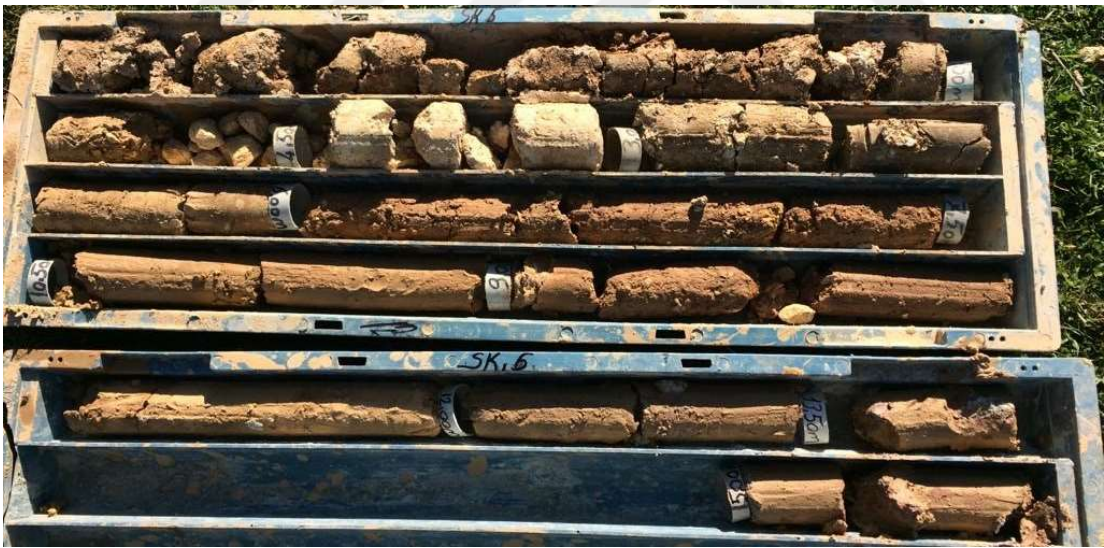
Şekil B.6 SK-6 kuyusu 0.00-15.00 metre karot sandığı.
