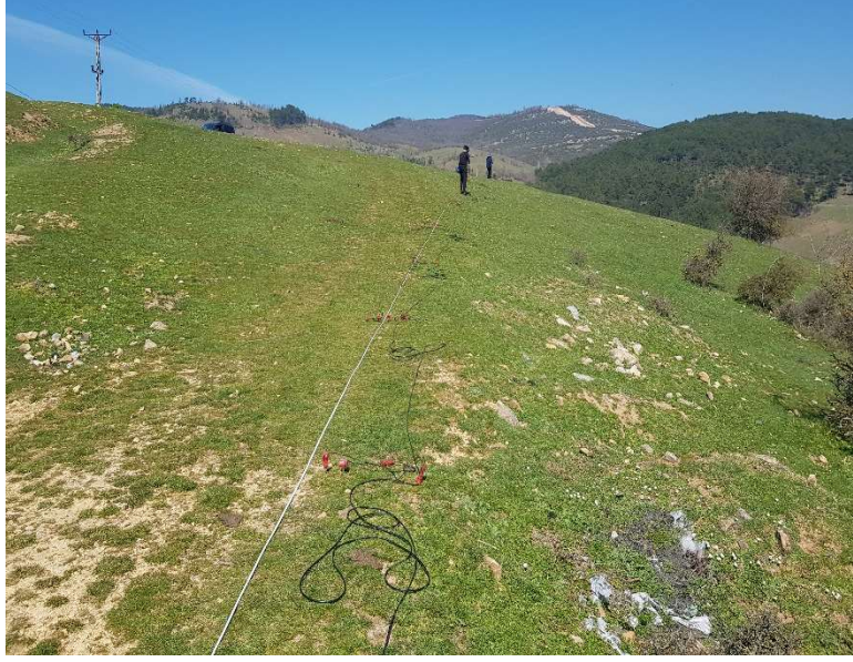
Şekil 5.2 SİS-2 nolu sismik kırılma çalışmasından genel görünüm (Arson 2019).
