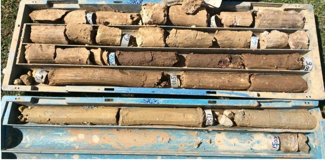
Şekil B.7 SK-7 kuyusu 0.00-15.00 metre karot sandığı.
