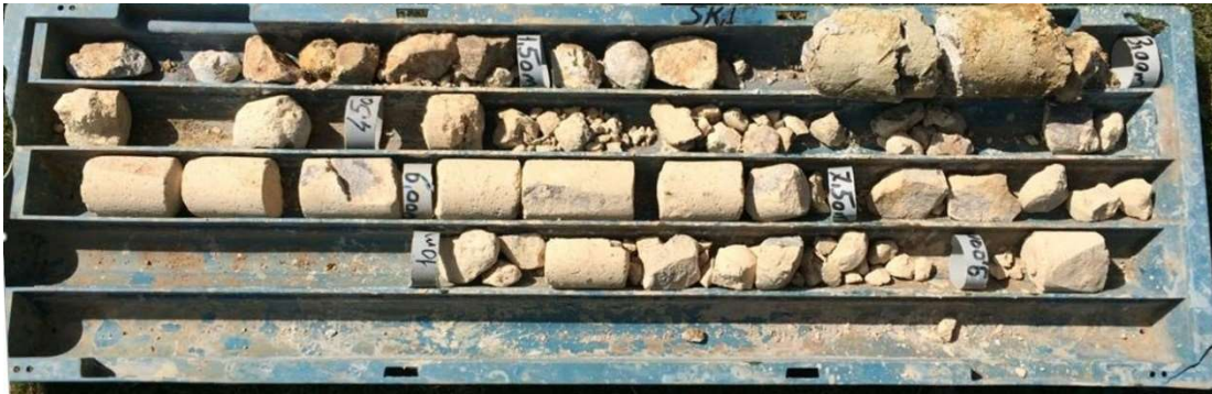
Şekil 4.2 İnceleme alanında açılmış 10 metrelik SK-1 nolu sondaj kuyusunda ait karot sandığı fotoğrafı.
