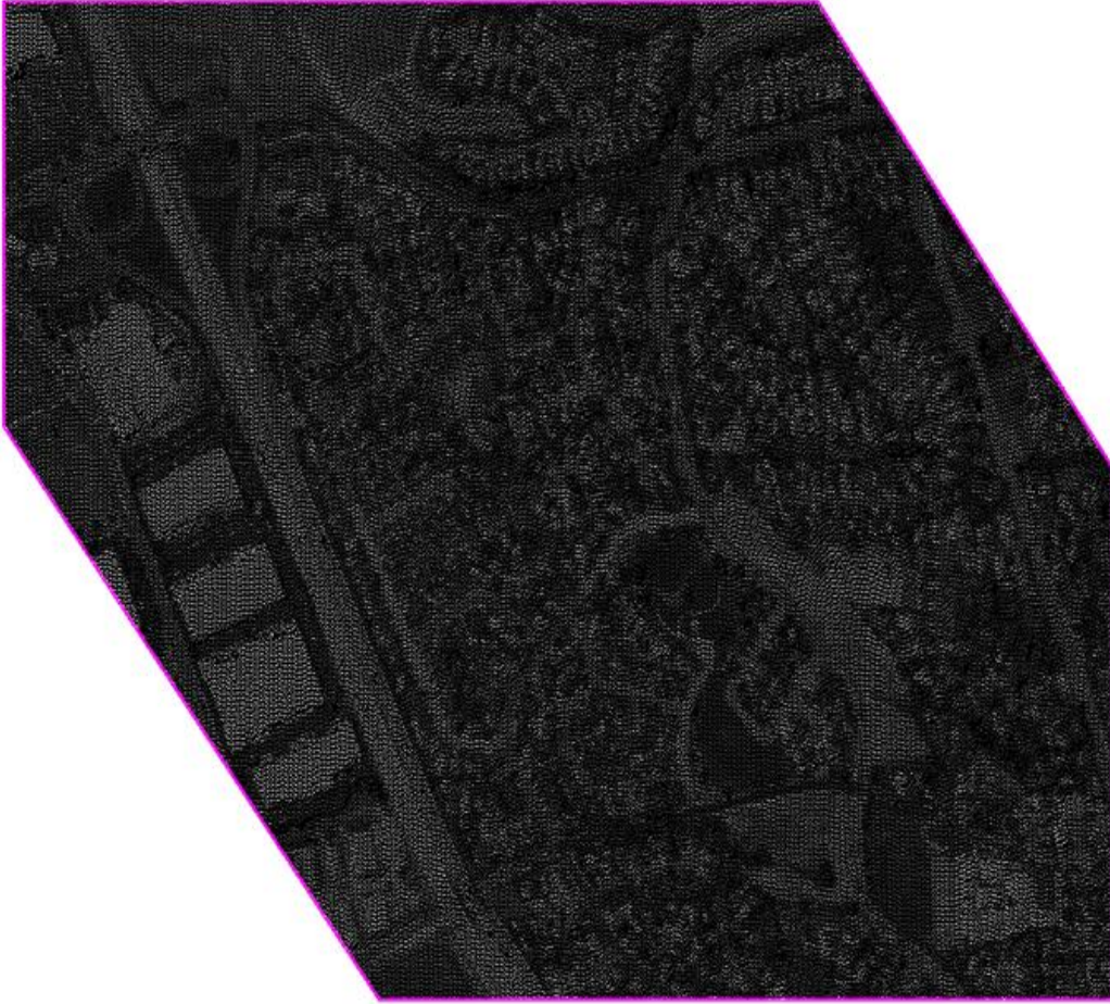
Şekil 3.4 Fotogrametrik nokta bulutu intensity (yoğunluk) haritası.
