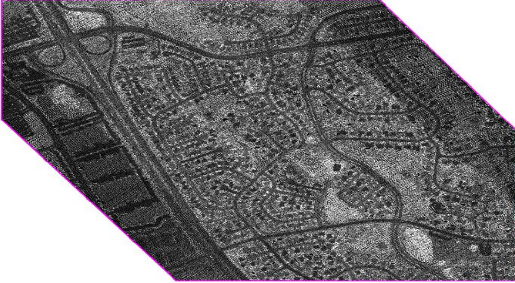
Şekil 3.6 ALS nokta bulutu intensity (yoğunluk) haritası.
