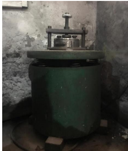
Şekil 4.6 Öğütme işleminde kullanılan bilezik değirmen.
