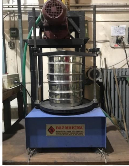
Şekil 4.7 Laboratuvar çalışmasında sınıflandırma için kullanılan titreşimli elek.
