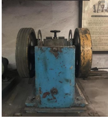
Şekil 4.4 Ocaktan alınan örneklerin boyut küçültmesinde kullanılan laboratuvar ölçekli çeneli kırıcı.
