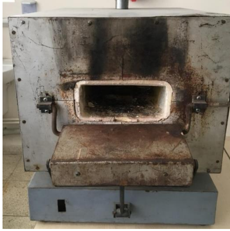
Şekil 3.2 Gerilim gidermede kullanılan fırın.
