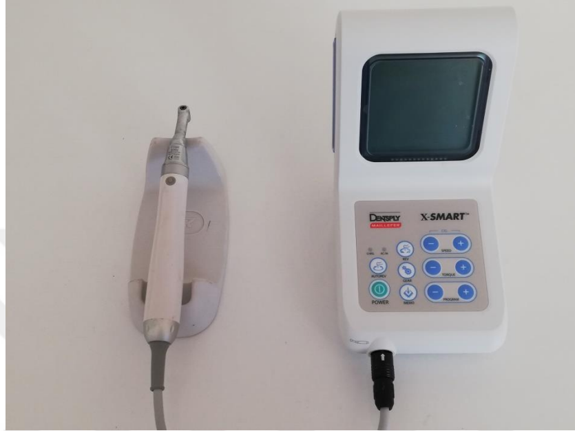
Resim 3: XSmart, Dentsply Maillefer marka tork kontrollü bir endodontik motor
