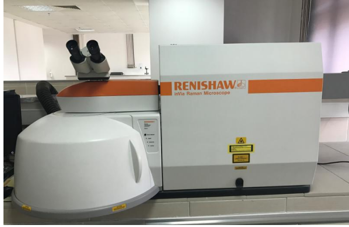
Resim 7. Raman analizi cihazı
