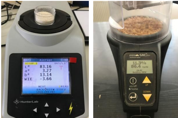
Şekil 3.18. Un rengi değeri ve Hektolitre Ağırlığı ölçümlerinin yapılması
