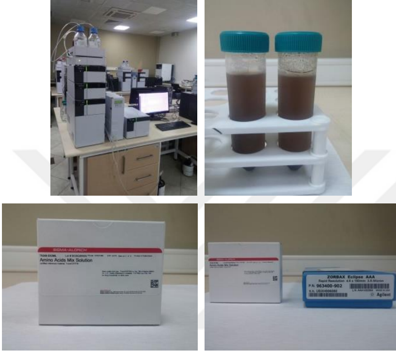
Şekil 3.22. Aminoasit ölçümlerinin yapılması kullanılan kolon ve standartlar
