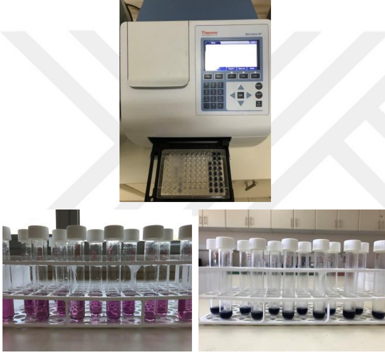
Şekil 3.21. Toplam fenol ve antioksidan aktivite absorbans ölçümler,
