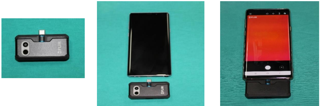
Şekil 8. FLIR ONE Pro termal kamera ve telefona bağlantısı
