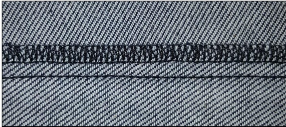
Şekil 4.14. Denim üreticisi firmada P5 kodlu kumaşa yapılan sürfile dikişleri (5 dik/cm)
