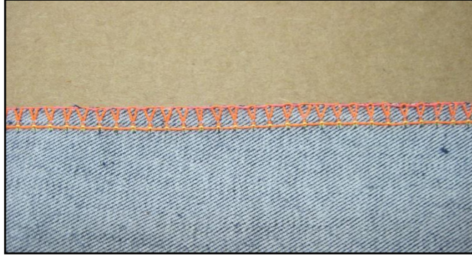
Şekil 4.18. Karşılıklı Çift Kafalı Sürfile Otomatı ile ET3 kodlu kumaşa yapılan sürfile dikişleri (3 dikiş/cm)
