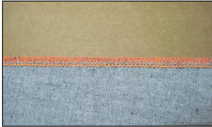
Şekil 4.20. Karşılıklı Çift Kafalı Sürfile Otomatı ile ET5 kodlu kumaşa yapılan sürfile dikişleri (5 dikiş/cm)
