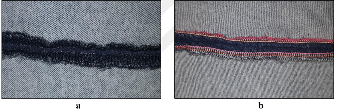
Şekil 4.27. a- Klasik overlok makinesi, b- Sürfile Otomatı ile dikilen ET5 numunesinin yıkama sonrası görüntüsü
