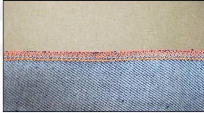
Şekil 4.16. Karşılıklı Çift Kafalı Sürfile Otomatı ile E4 kodlu kumaşa yapılan sürfile dikişleri (4 dikiş/cm)
