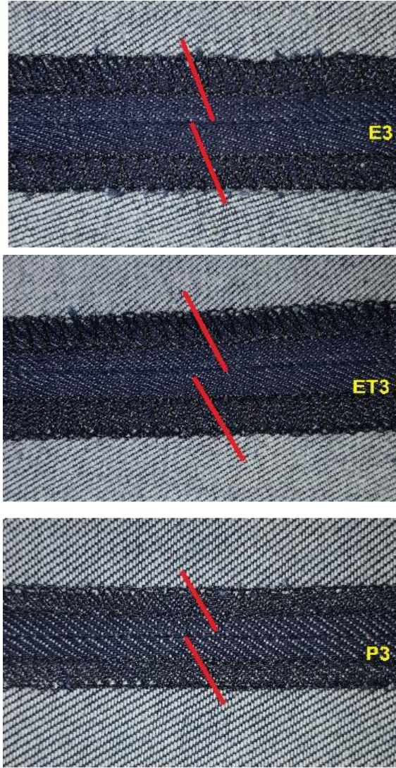
Şekil 4.24. Klasik overlok makinesi ile elde edilen kot pantolon paçalarındaki dikişlerin pozisyonu
