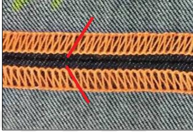
Şekil 2.15. “Karşılıklı Çift Kafalı Sürfile Otomatı”nda pantolon birleştirme dikişleri konumu
