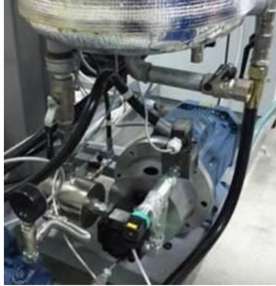
Şekil 3.8. Tez Materyalinde Tercih Edilen Dişli Pompa
