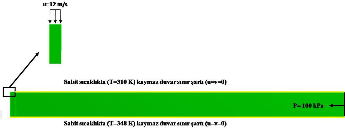
Şekil 3.37. Van Heiningen Geometrisi sınır koşulları
