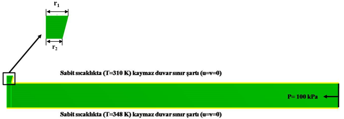
Şekil E1.1. Hızın hesaplandığı kontrol hacmi ve uygulanan sınır koşulları
