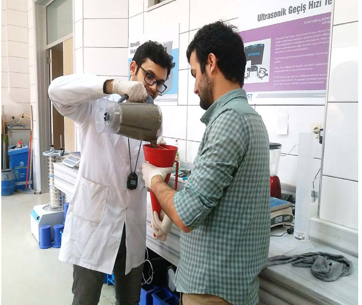
Şekil 3.3. Hamur karışımlarının Marsh-hunisi akış süresi deneyi görünümü
