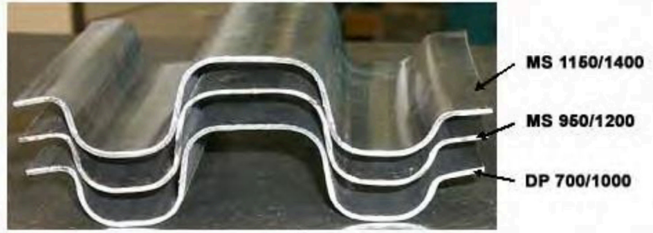
Şekil 3.4 Farklı Sacların Aynı Makaralardan Geçirilmesi Sonucu Elde Edilen Kesitler
