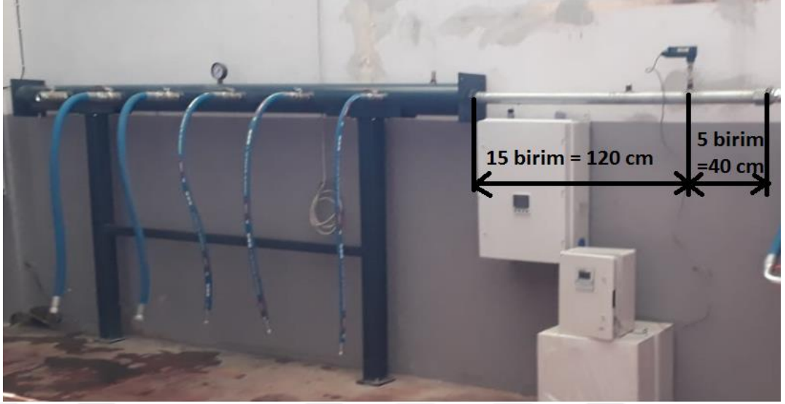
Şekil 3.15. Debimetrenin düz boru üzerindeki yerleşimi
