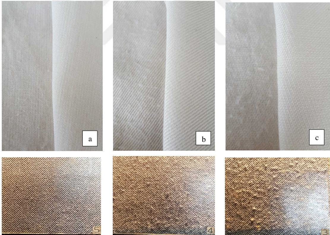
Şekil 4.17. Bezayağı (a), dimi (b) ve saten (c) örgülü pamuk atkılı kumaşların boncuklanma dayanımı
