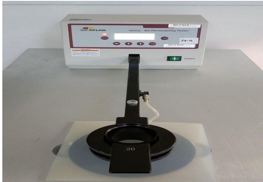
Şekil 3.5. Hava geçirgenliği test cihazı
