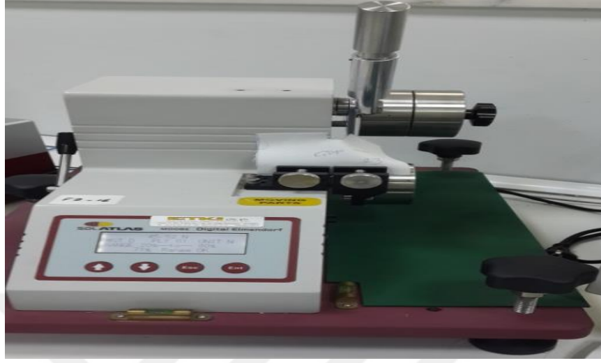
Şekil 3.8. Dijital Elmendorf cihazı
