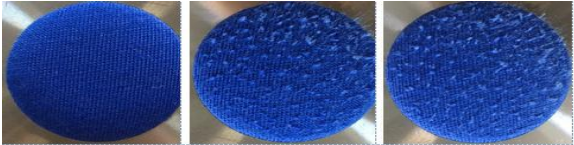
Şekil 4.7. Pes lifinin sırasıyla, işlem görmemiş, 5 000 ve 10 000 devirdeki görüntüleri
