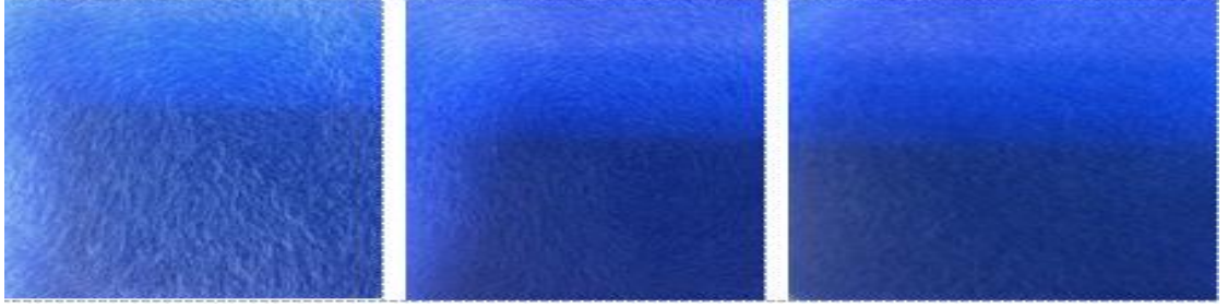
Şekil 4.4. Pamuk lifinin sırasıyla 10 000, 20 000 ve 30 000 devirdeki yüzey görüntüleri
