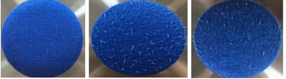
Şekil 4.10. Umorfil/pamuk karışım lifinin sırasıyla, işlem görmemiş, 5 000 ve 10 000 devirdeki görüntüleri
