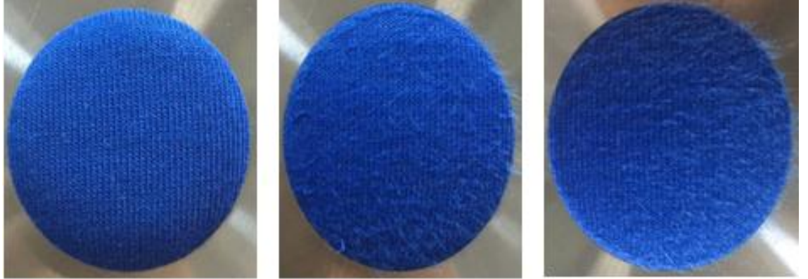
Şekil 4.11. Umorfil (Protein) lifinin sırasıyla, işlem görmemiş, 5 000 ve 10 000 devirdeki görüntüleri
