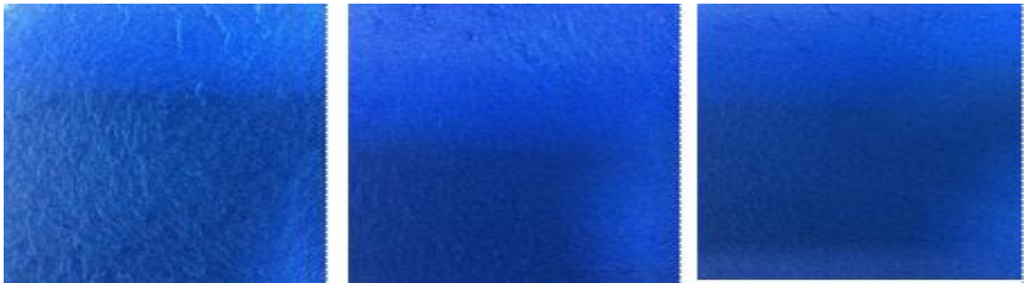
Şekil 4.3. Viskon lifinin sırasıyla 10 000, 20 000 ve 30 000 devirdeki yüzey görüntüleri
