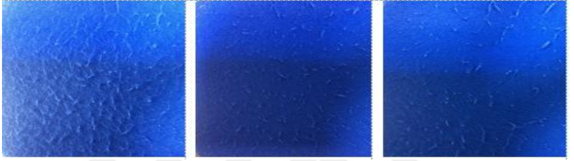
Şekil 4.2. Polyester lifinin sırasıyla 10 000, 20 000 ve 30 000 devirdeki yüzey görüntüleri
