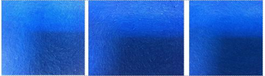
Şekil 4.5. Umorfil/pamuk karışım lifinin sırasıyla 10 000, 20 000 ve 30 000 devirdeki yüzey görüntüleri
