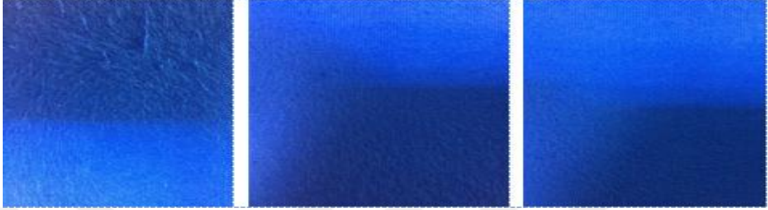
Şekil 4.6. Umorfil (Protein) lifinin sırasıyla 10 000, 20 000 ve 30 000 devirdeki yüzey görüntüleri
