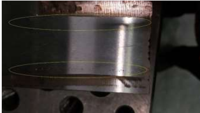
Şekil 2.17. Malzemede oluşmuş gaz boşlukları
