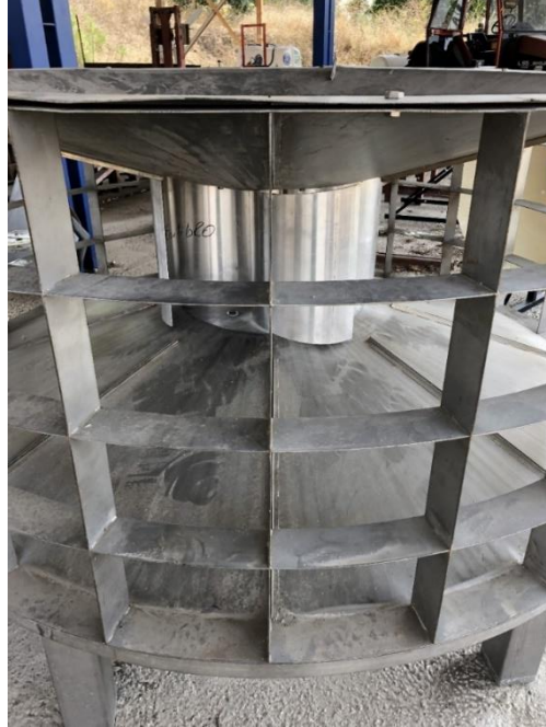
Şekil 3.6. Yoğunlaştırma sistemi ile birlikte Savonius Rüzgar Türbini
