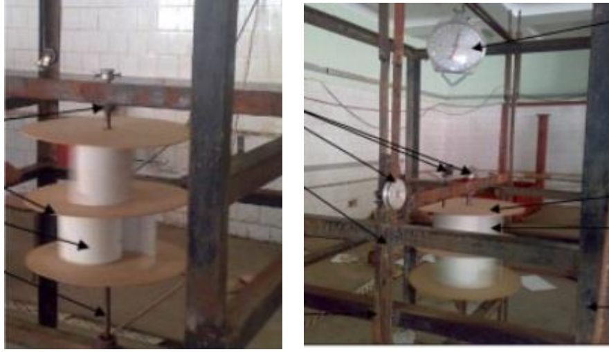
Şekil 2.10. Tek ve çift kademeli Savonius rüzgar türbini (Mahmoud ve ark. 2012)
