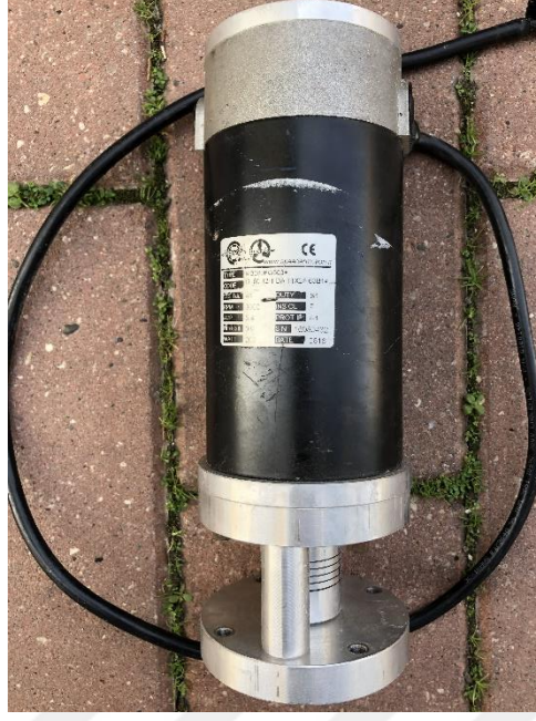
Şekil 3.5. Sistemde elektrik jeneratörü olarak kullanılacak DC motor
