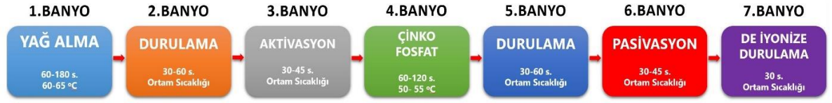
Şekil 2.2. Tipik çinko fosfatlama hattı sıralaması
