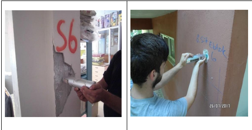
Şekil 2.11. Test çekici (tahribatsız yöntem) işlemi örneği
