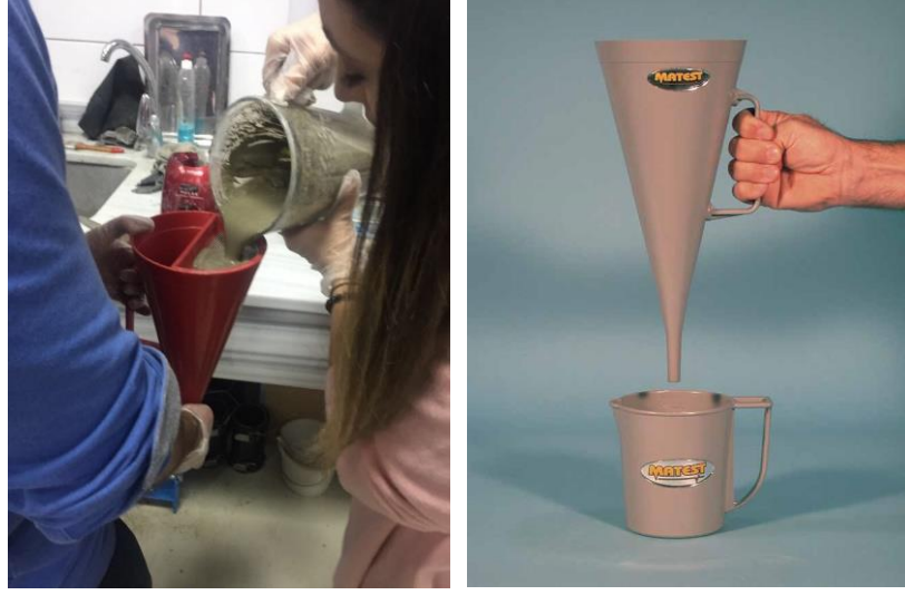
Şekil 3.3. Marsh hunisi akış süresi deneyinin uygulaması
