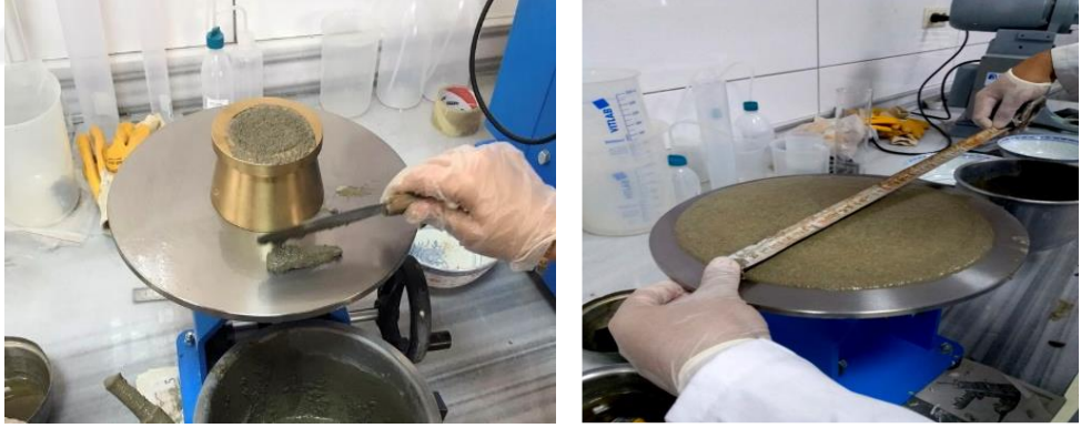
Şekil 3.5. Harç karışımlarının yayılma deneyinden görünüm
