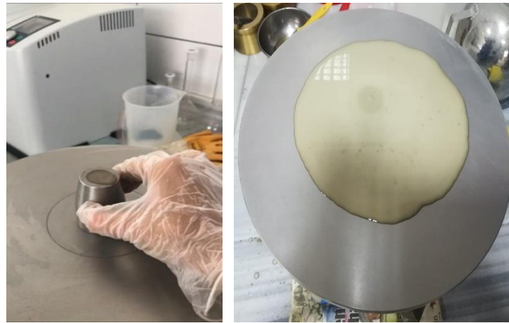
Şekil 3.4. Mini çökme deneyinin uygulaması
