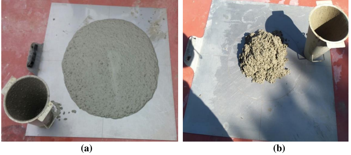
Şekil 4.7. Kontrol karışımının a) 0. dakikada, b) 20. dakikadaki yayılma deneyi
