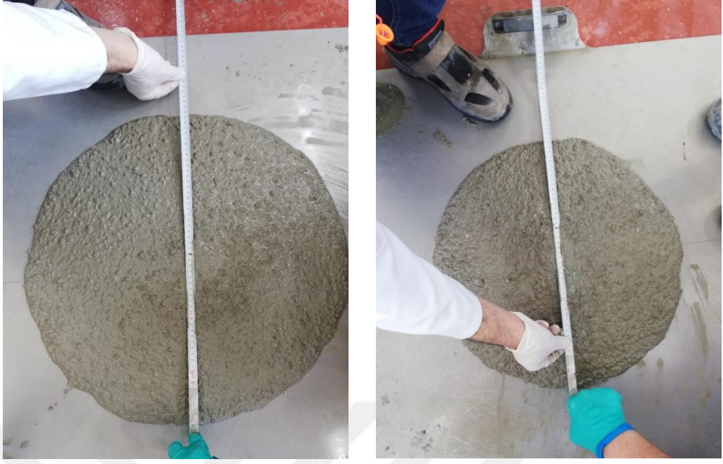
Şekil 4.22. S10 katkısının 0. ve 60. dakikada yayılmasının ölçülmesi
