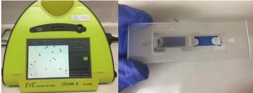
Resim 15. Otomatik hücre sayımının yapıldığı cihaz ve hücrelerin sayıldığı thoma lamı
