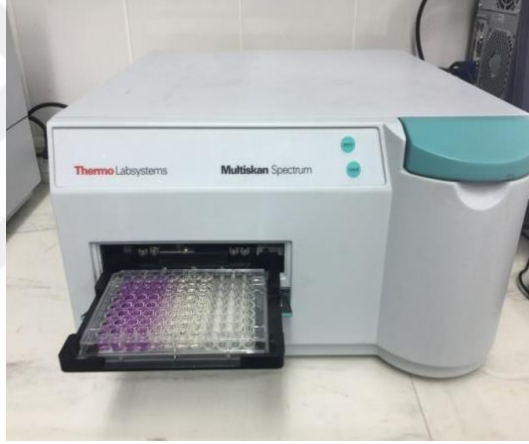
Resim 17. MTT ve apoptoz denemelerinin plaklarının okunduğu mikroplak okuyucu
